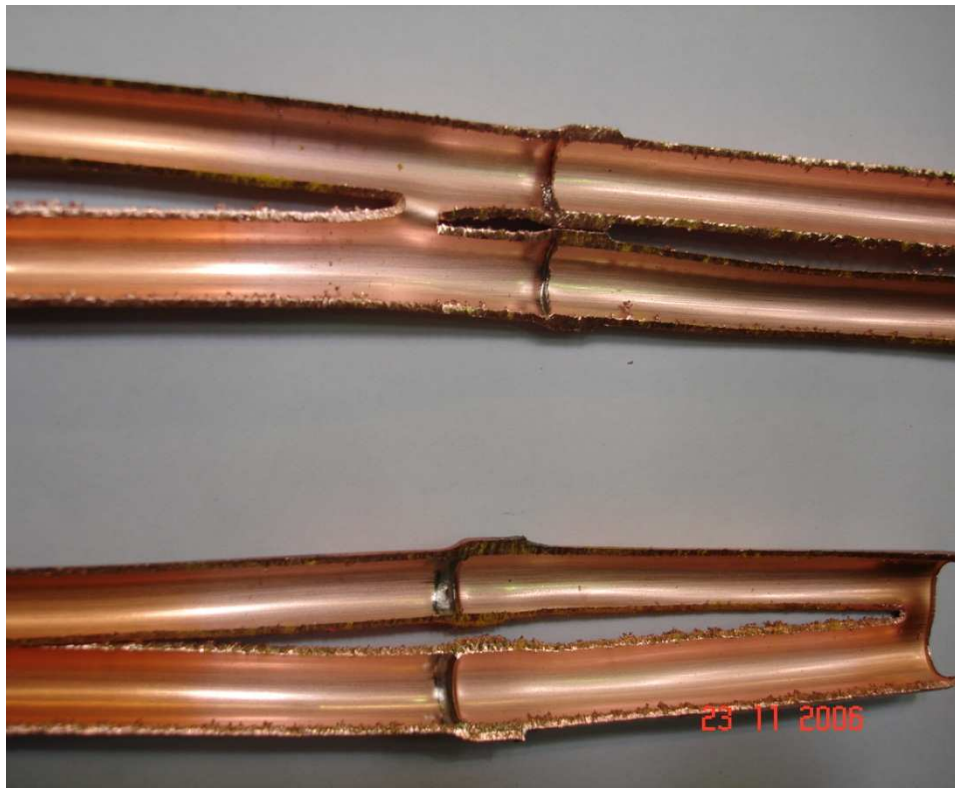
Soldagem com fluxo de N 2
