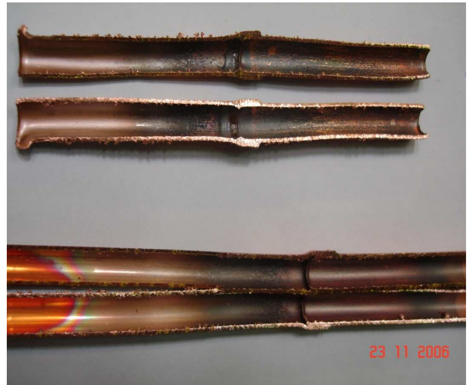
Soldagem sem fluxo de N 2
